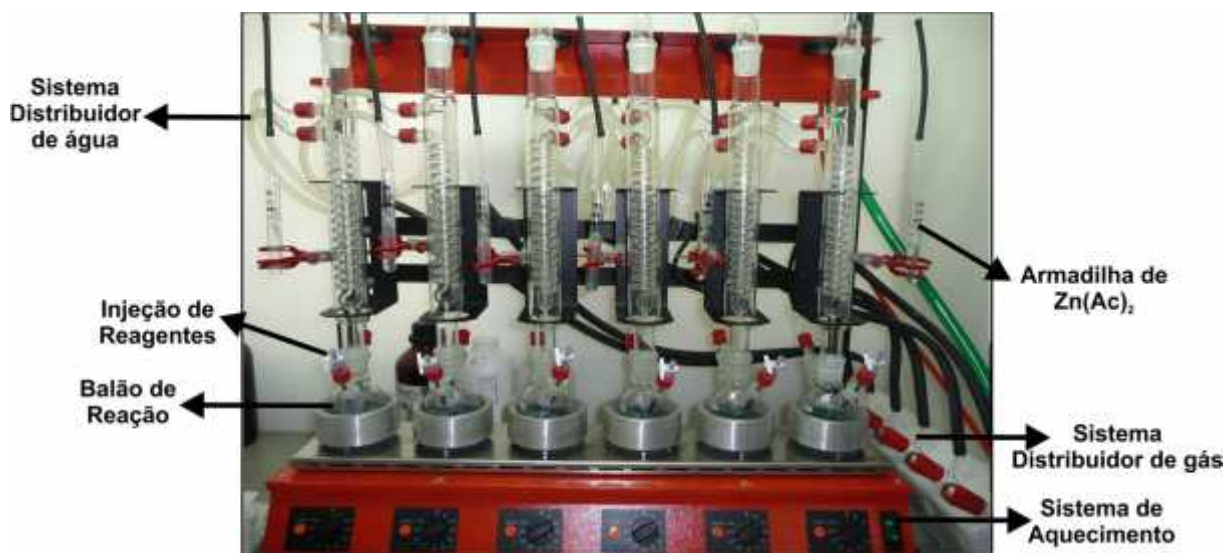
Figura 16 - Sistema de destilação do AVS-CRS montado no Laboratório de Oceanografia Operacional e Paleoceanografia (LOOP) do Departamento de Geoquímica da UFF.
